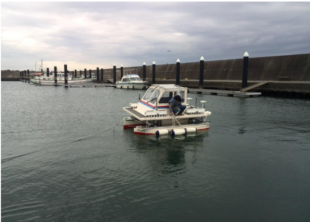
波エネルギーを収穫して動揺を抑制する小型船の実海域実験（北澤研究室）
