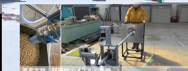
要素実験：餌補給・ノズルの接続
