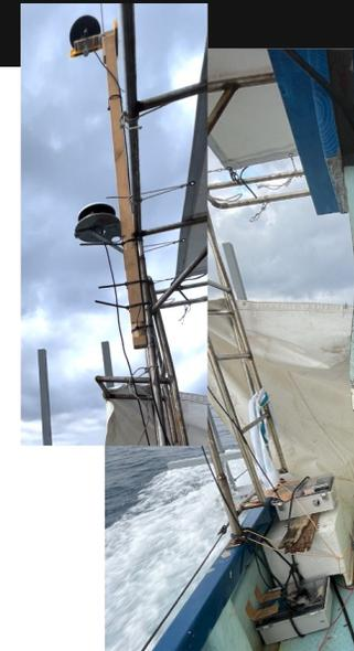
みちびきGPSアンテナと受信装置
