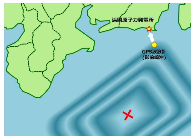
観測値に換算係数を掛け合わせ 浜岡地点の到達時刻・高さを予測
