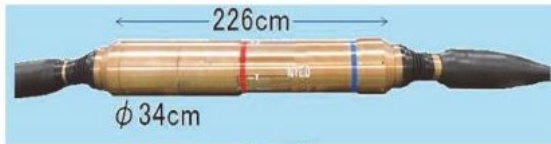
地震計と津波計の 一体型観測装置
