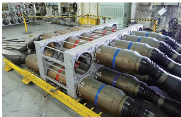
図3 海底に設置する観測装置(例)
