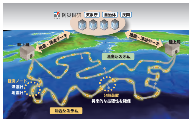
図2 南海トラフ海底地震津波観測網(N-net)イメージ図
