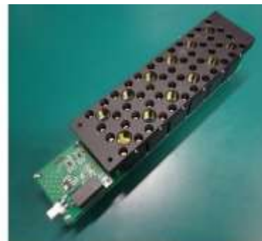
複数のPMTを集約したPMTモジュール
