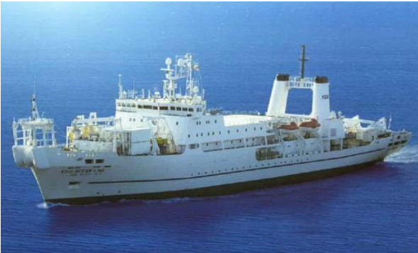
【KDDIオーシャンリンク】1992年建造 全長: 133.5 m/ 全幅: 19.6 m ケーブルタンク: 5,000 ton 宿泊居室: 85 名分
