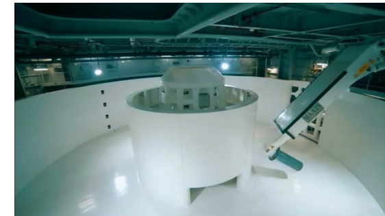
バスケット型ターンテーブルを1基装備、電力ケーブル敷設にも対応可能
