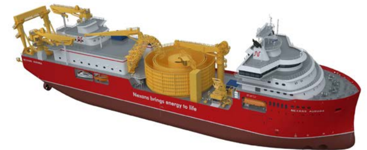
【Nexans】 2020年就航予定 全長: 150 m/ 全幅: 31 m ケーブルタンク: 10,000 ton 宿泊居室: 90 名分
