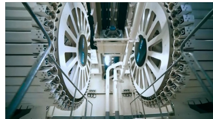
直径4m、40トンの巻揚げ能力をもつセルフフリート式電動ドラムケーブルエンジン（DCE）を2基搭載（通信ケーブルハンドリング用）
