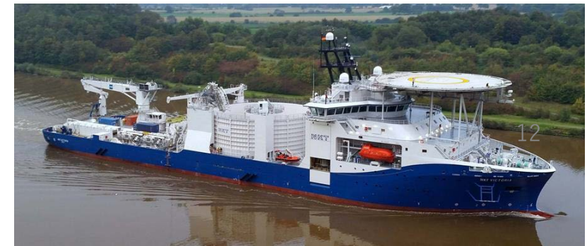
【ABB (NKT)社】 2017年建造 全長: 140 m/ 全幅: 30 m ケーブルタンク: 7,000 ton & 4,500 ton 宿泊居室: 100 名分
