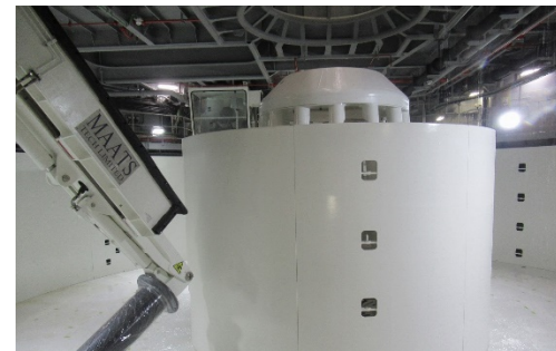
バスケット型ターンテーブルを1基装備、電力ケーブル敷設にも対応可能
