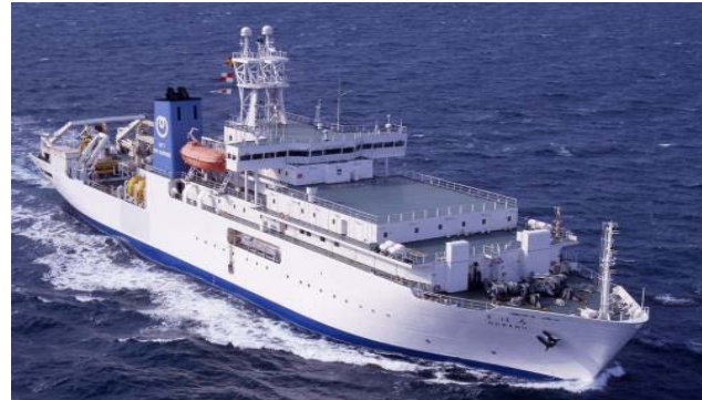
【NTT-WEM】SUBARU 1999年建造 全長: 123.3 m/ 全幅: 21 m ケーブルタンク: 5,000 ton 宿泊居室: 80 名分
