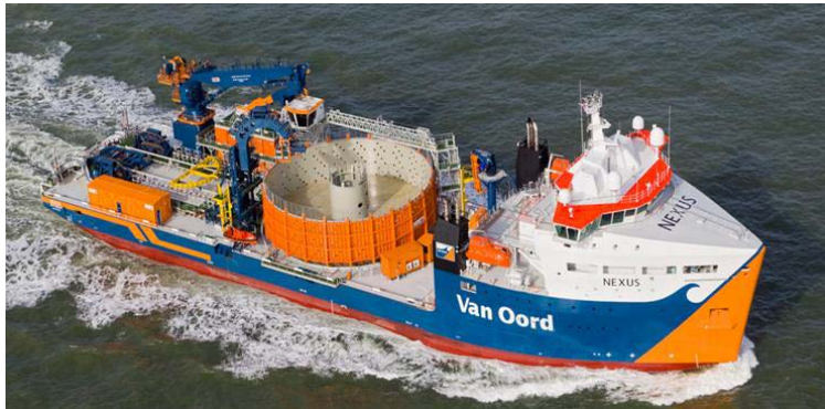
【Van Oord社】 2014年建造 全長: 123 m/ 全幅: 27 m ケーブルタンク: 5,000 ton 宿泊居室: 90 名分
