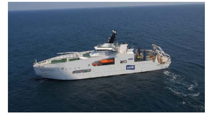
【KDDIケーブルインフィニティ】 2019年建造, 全長: 113.1 m/ 全幅: 21 m ケーブルタンク: 4,500 ton 宿泊居室: 80 名分
