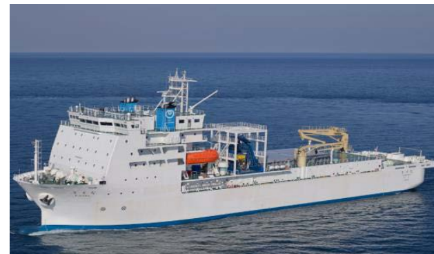
【NTT-WEM】きずな2017年建造 全長: 109 m/ 全幅: 20 m ケーブルタンク: 2,500 ton 宿泊居室: 60 名分
