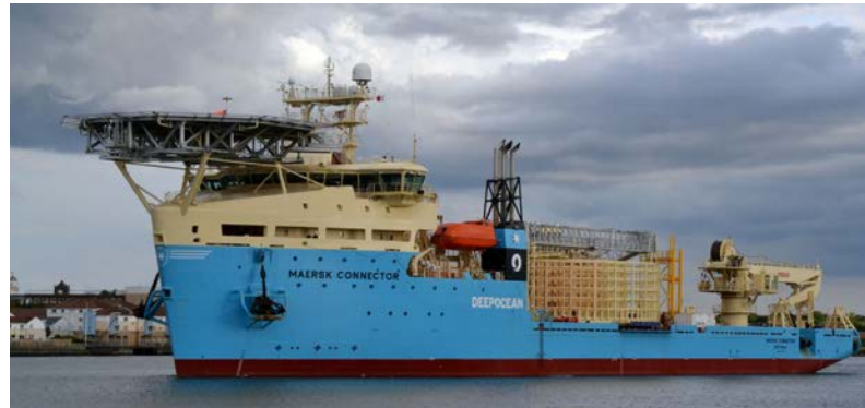
【Maersk社】 2016年建造 全長: 138 m/ 全幅: 27 m ケーブルタンク: 7,000 ton 宿泊居室: 90 名分
