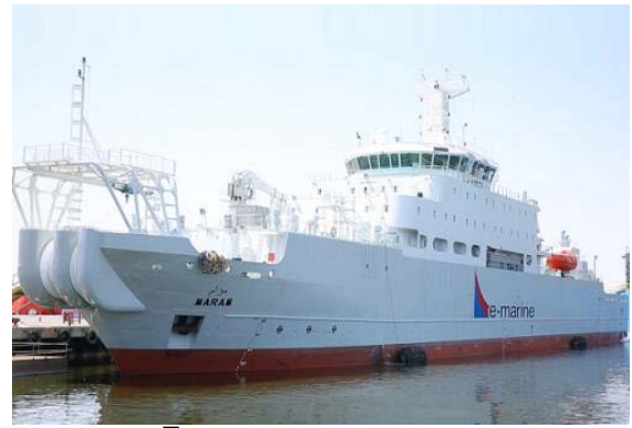
【E-Marine】CS MARAM 2016年建造 全長: 126.5 m/ 全幅: 16.6 m ケーブルタンク: 2,700 ton 宿泊居室: 72 名分
