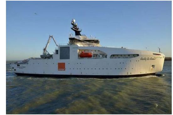
【Orange Marine】Pierre de Fermat 2014年建造, 全長: 123.3 m/ 全幅: 21 m ケーブルタンク: 5,000 ton 宿泊居室: 80 名分
