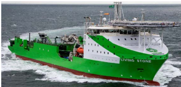
【DEME社】 2018年建造 全長: 161 m/ 全幅: 32 m ケーブルタンク: 5,000 ton & 5,000 ton、宿泊居室: 100 名分
