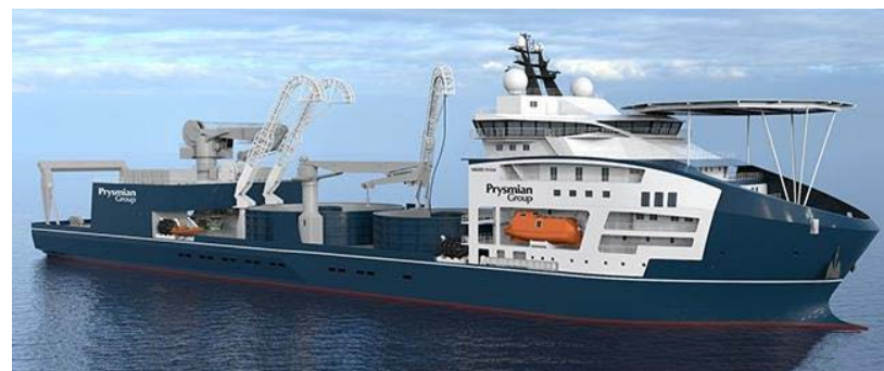
【Prysmian】 2020年就航予定 全長: 172 m/ 全幅: 34 m ケーブルタンク: 7,000 ton & 7,000 ton、宿泊居室: 120 名分
