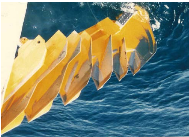
KS-2 Cable Burier 埋設深度 0.7m
